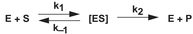
Abbildung 129: Teilschritte einer enzymatischen Reaktion: Gleichgewicht zur Bildung des Enzym-Substrat-Komplexes und die enzymkatalysierte Reaktion.
